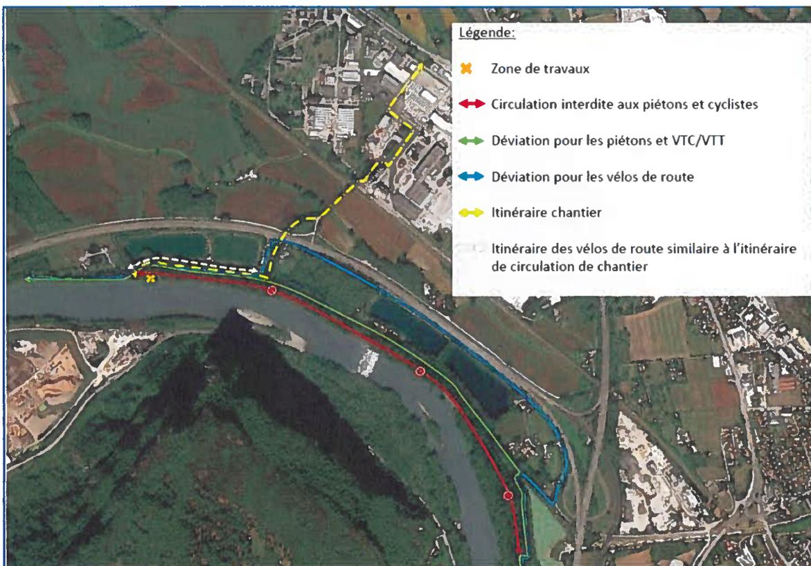
Figure 1 : Plan de circulation et de déviation
